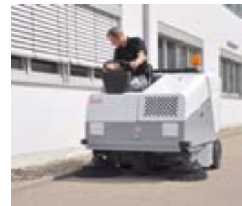
Die patentierte Seitenbesenabsaugung ermöglicht staubfreies Kehren mit dem Seitenbesen. (Sweep 90 / 100 / 120)
