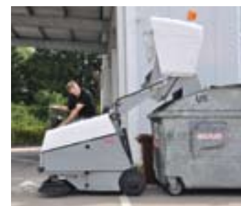
Hydraulische Hochentleerung bis maximal 147 cm und maximal 400 l. Hier die Sweep 100 AHB.
