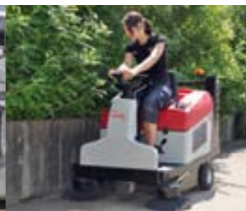
Sweep 71 AH: Randnahe Arbeiten.
