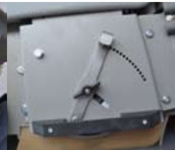
Sweep CS60 AB: Einfache Verstellbarkeit der Bürsthöhe.
