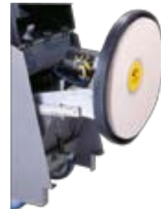
Leichter Padwechsel durch hochklappbare Poliereinheit.
