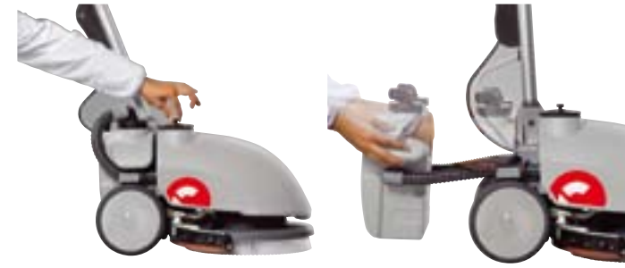
Einfache Befüllung des Frischwassertanks.
