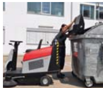
Sweep 71 AH: Hochentleerung bis 130 cm.
