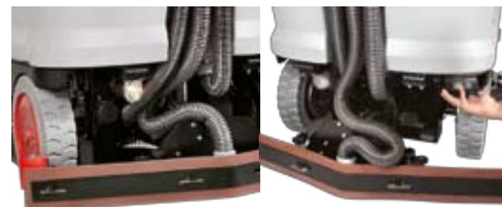
Schwerer Saugfuß für optimale Absaugung.
